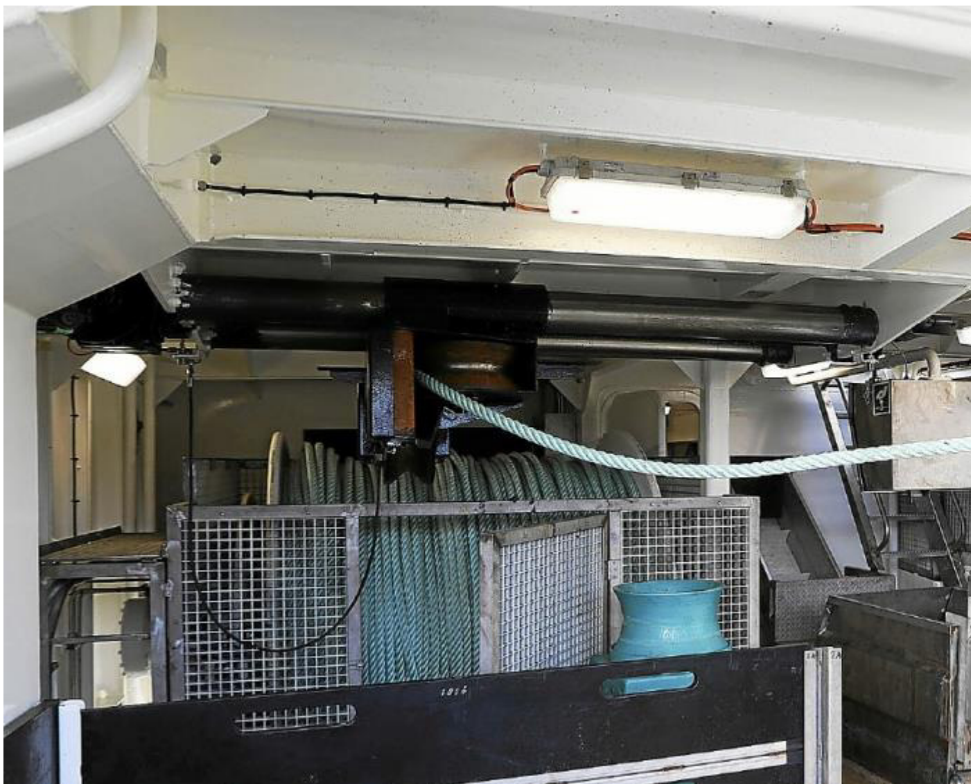
Les treuils de senne et de chalut ont été installés sur deux ponts différents.
